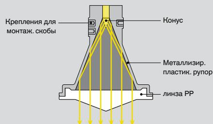
Импедансный конус равномерно распределяет микроволны внутри антенны. Металлизированная внутренняя поверхность направляет сигнал на продукт.
