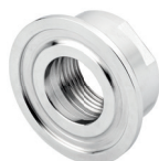
Зажимный штуцер с буртиком DN 40 (DIN 11864-3)
