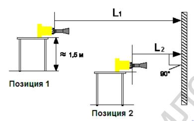
устанавливают в позицию 1 на расстояние L1, проводят измерения и записывают в протокол измеренные значения расстояния L и Ly в позиции 1 по рулетке (L) и с дисплея модуля индикации и настройки уровнемера (Ly).
