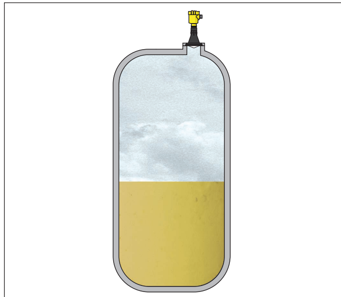
Рис. 26: Измерение уровня в резервуаре с кислотой с помощью VEGAPULS 61
