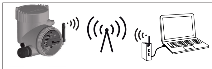
Рис. 36: Передача измеренных значений и удаленное параметрирование датчика через мобильную сеть
