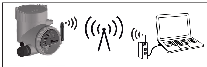
Рис. 50: Передача измеренных значений и удаленное параметрирование датчика через мобильную сеть
