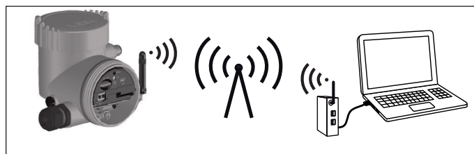
Рис. 40: Передача измеренных значений и удаленное параметрирование датчика через мобильную сеть
