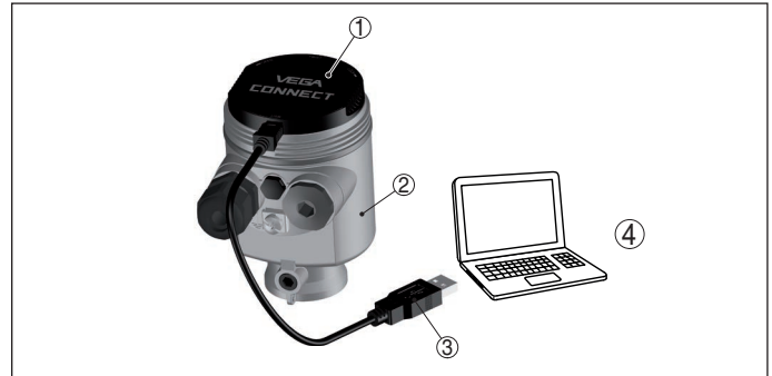
Рис. 34: Подключение к ПК через VEGACONNECT и USB
