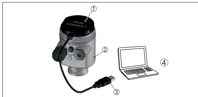
Рис. 54: Подключение к ПК через VEGACONNECT и USB
