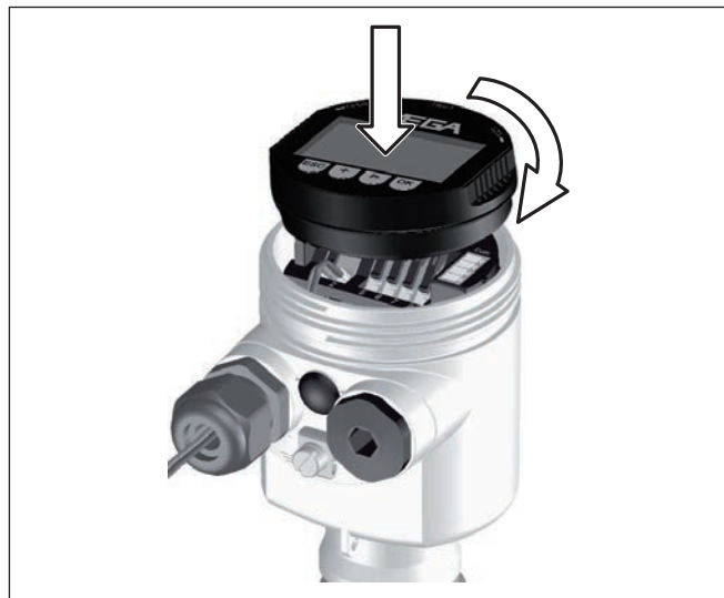
Рис. 6: Установка модуля индикации и настройки
