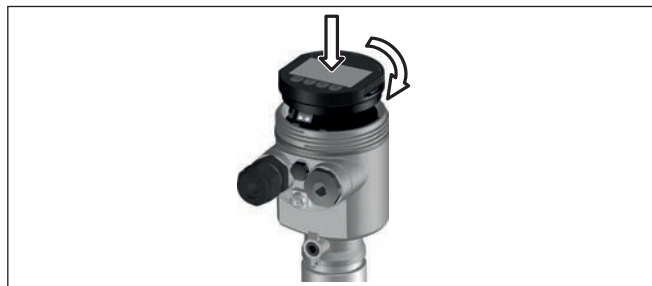
Рис. 6: Установка модуля индикации и настройки в отсеке электроники однокамерного корпуса
