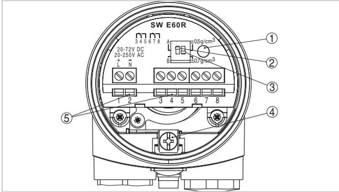
Отсек электроники и подключения (однокамерный корпус)
