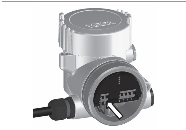
Рис. 4: Шаги подключения 5 и 6 - двухкамерный корпус
